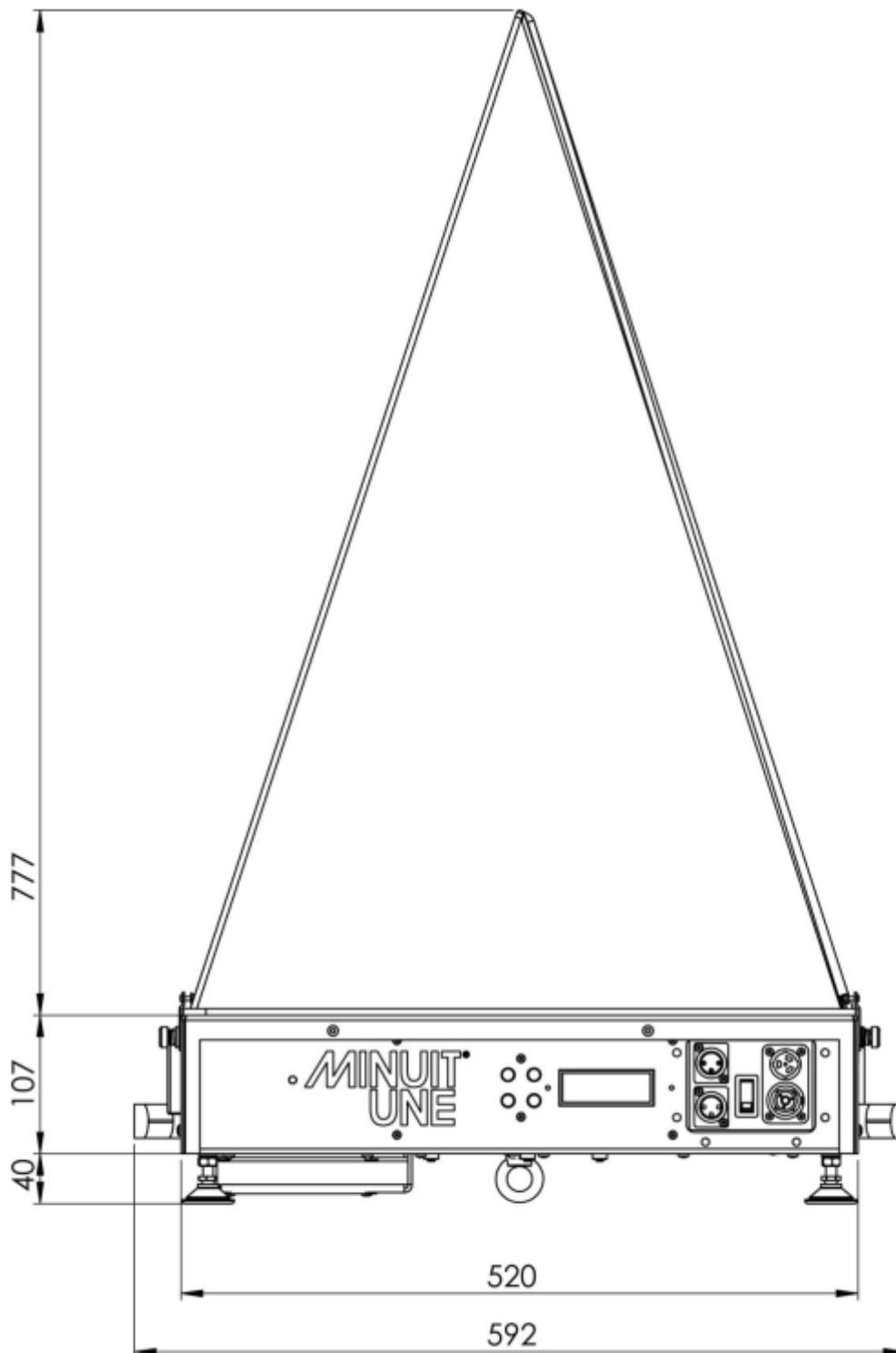
**FIGURE 2 : IVL PYRAMID DIMENSIONS**
