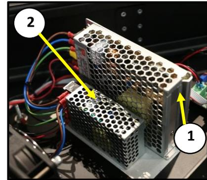
FIGURE 33 : POWER SUPPLY UNITS
