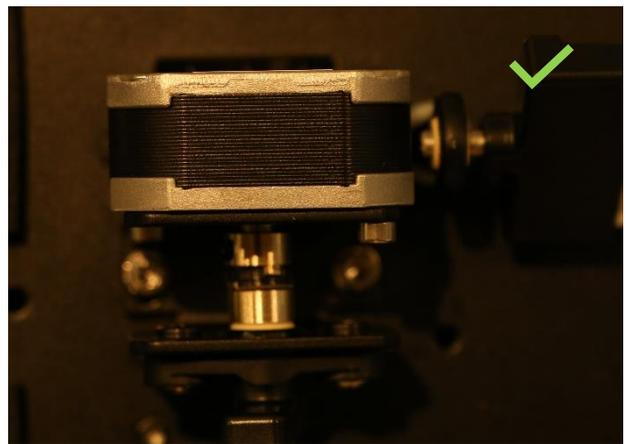
FIGURE 70: GOOD MOTOR ORIENTATION
