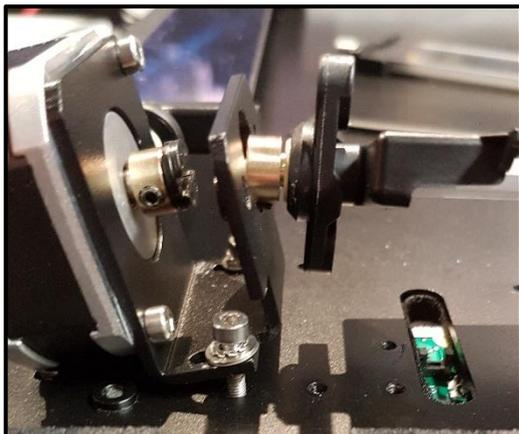
FIGURE 79: INCLINE THE STEPPER MOTOR SUPPORT
