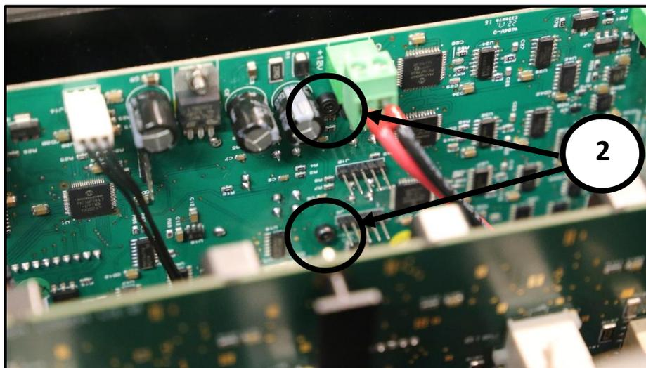
FIGURE 47: HOLD THE SCREWS INSIDE
