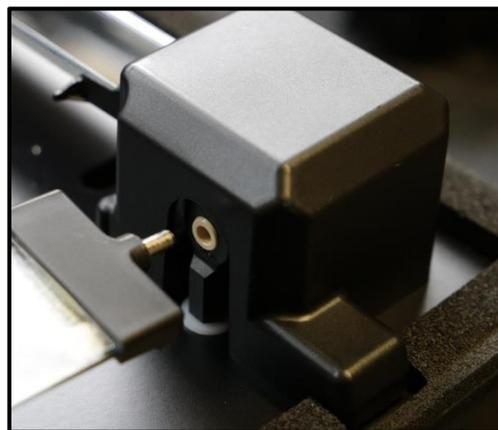
FIGURE 80: INCLINE THE STEPPER MOTOR SUPPORT
