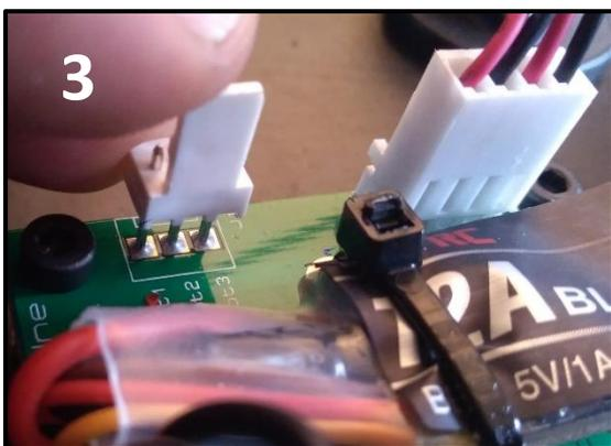
FIGURE 58: REVERSE THE POLARIZER
