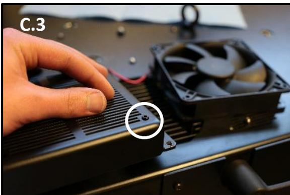
FIGURE 43: PIN INSERT
